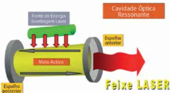
Fig. 1 | Um laser é constituído fundamentalmente por um meio activo que permita a transmissão de luz no seu seio (Ex.: Nd:YAG, Argon, Rubi, CO 2 ), um sistema de espelhos colocados nas extremidades do meio activo, habitualmente com forma cilíndrica, a fim de permitir construir uma cavidade óptica ressonante, um sistema de fornecimento de energia ao meio activo ou seja um sistema de bombagem laser ( Ex.: uma lâmpada de flash, um outro laser, um diodo, um arco eléctrico) e um sistema de saída com mecanismos de regulação da saída do feixe laser. Convém referir que o espelho posterior é 100% reflector e levemente côncavo e o anterior é menos do que 100% reflector.
